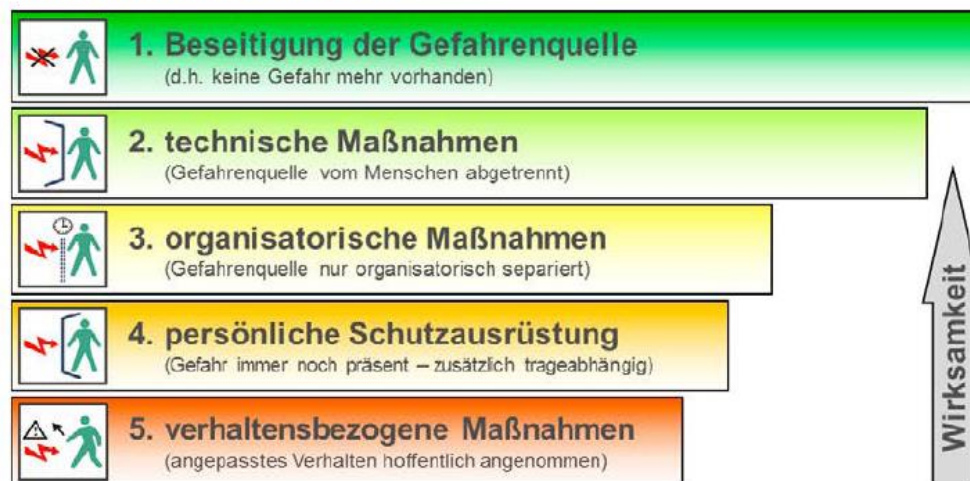
Bild 1: Hierarchie der Maßnahmen im Arbeitsschutz. (Bildquelle: Berufsgenossenschaft Holz und Metall BGHM-Information 102: Beurteilen von Gefährdungen und Belastungen. Anleitungshilfe zur systematischen Vorgehensweise, sichere Schritte zum Ziel, 2015)
