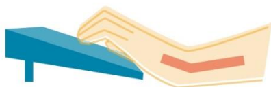
Bild 1: Hochgestellte Tastatur ohne Handballenauflage und als Folge angespannte Handhaltung. (Bild: Chiarina Fazio, Rechte: ergo-online)
