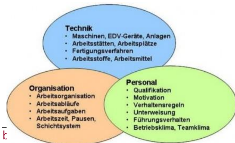
Bild 1: Grundlegende Ansatzpunkte zur sicheren und gesundheitsgerechten Gestaltung von Arbeitssystemen. (Quelle: Handbuch Arbeitsschutz, Bund-Verlag 2005)
